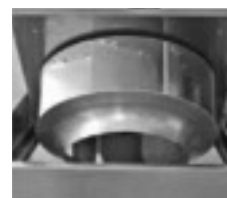
Откидывающаяся крышка корпуса вентилятора
