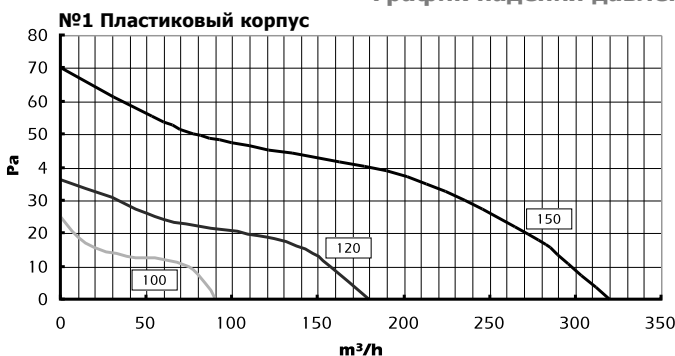
График падения давления вентилятора TUBO
