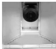
Двигатель отделён от воздушного потока
