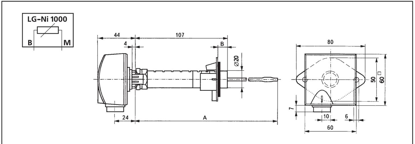
Рис. 4. Принципиальная схема и размеры (A=400 мм, B<sub>max</sub>= 70 мм, B<sub>min</sub>= 10 мм)
