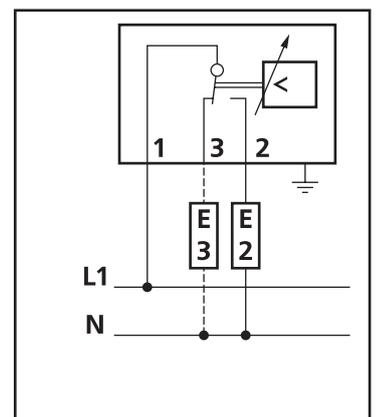
Контакты «1-2» термостата замыкаются при температуре ниже температуры уставки.
