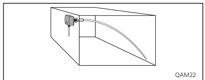
Рис. 3. Пример установки датчика
