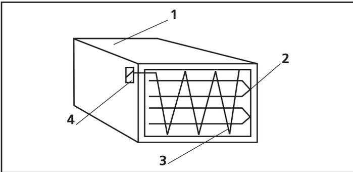
Рис. 7. Схема установки чувствительного элемента датчика-реле температуры
