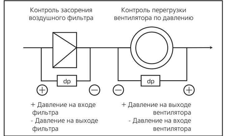
Рис. 9. Схема подключения датчика-реле давления
