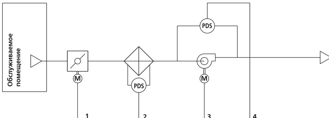
Система вентиляции (вытяжки) содержит следующие элементы:
